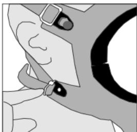
Após o uso, desconectar a válvula de demanda da máscara e apertar o botão central da válvula para cessar a saída do ar. Para tirar a peça facial insira o dedo indicador atrás da trava da máscara e empurre para frente com o dedo polegar. Abra primeiro a tira inferior, depois a do meio e por fim a superior. Puxe a máscara para frente e tire-a do rosto puxando o tirante por sobre a cabeça.
