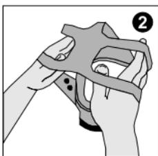
**2** Segure as alças do tirante bem esticadas, passe-as por cima da cabeça e coloque o queixo na parte inferior da mascarilha interna.
