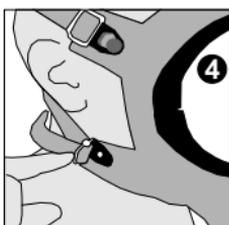
*Após o uso, desconectar a válvula de demanda da máscara e apertar o botão central da válvula para cessar a saída do ar. Para tirar a peça facial insira o dedo indicador atrás da trava da máscara e empurre para frente com o dedo polegar. Abra primeiro a tira inferior, depois a do meio e por fim a superior. Puxe a máscara para frente e tire-a do rosto puxando o tirante por sobre a cabeça.*
