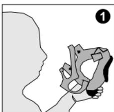
**1** Ter a peça facial à disposição para colocação. Retirar o formador (peça branca) do corpo da máscara.
