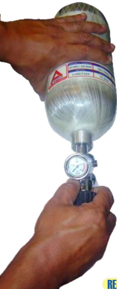
1. Despressurizar por completo o cilindro antes de iniciar a remoção da válvula.
